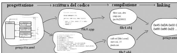
Figura 1.2: Il processo di sviluppo di un'applicazione, dalla progettazione al linking.
